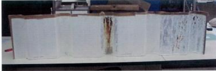
Foto: Se observa la chapa galvanizada con las zonas no pintadas y las zonas pintadas.
